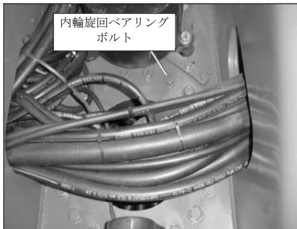
図 7.11 - 回転ベアリングボルト
