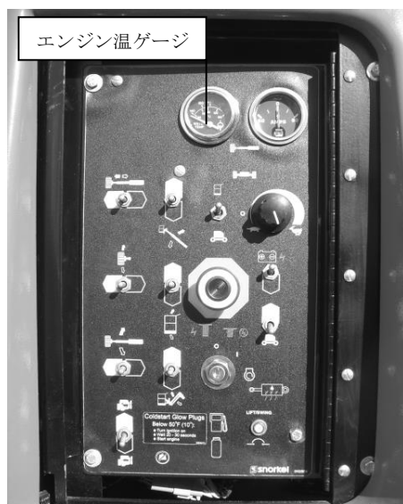
図 4.6—車体側操作盤
