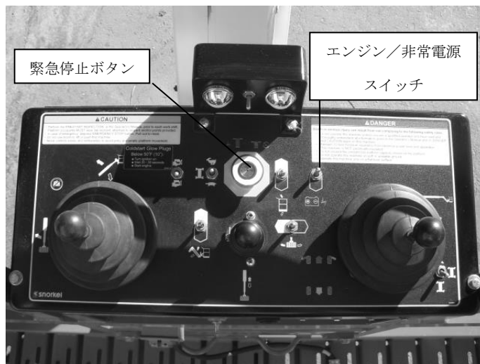
図 4.2ー作業床側操作盤・緊急停止ボタン
