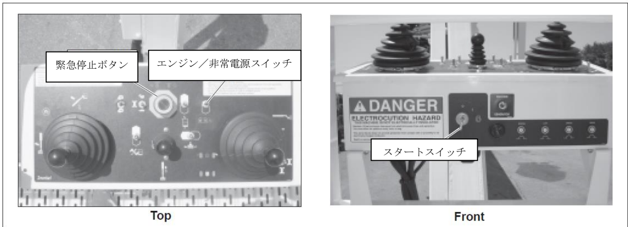
図 10.3-作業床操作盤
