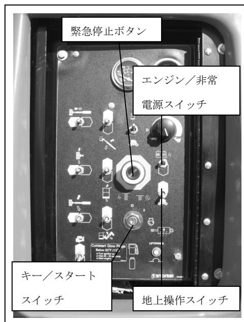
図 8.1-車体側操作盤
