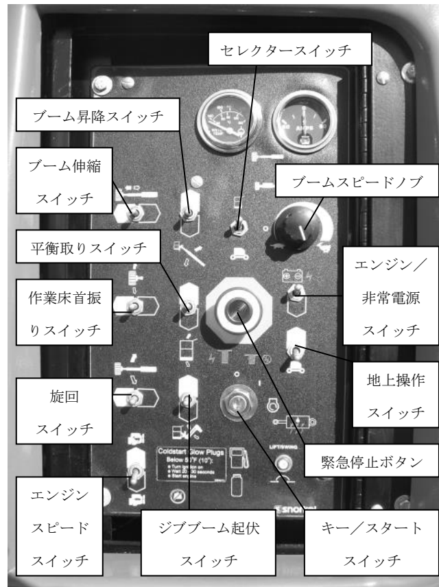
図 6.2-車体側操作盤
