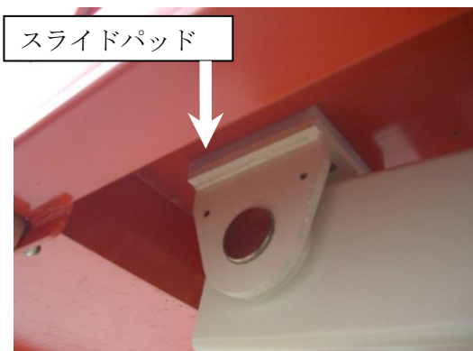
図 作業床側スライドパッド
