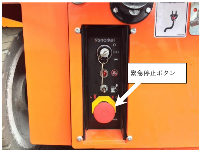
図 下部操作盤・緊急停止ボタン
