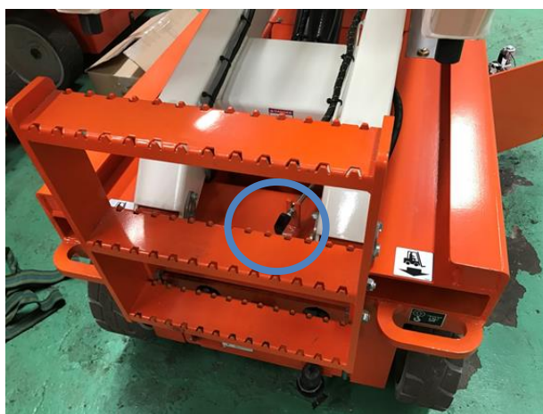
図 シャーシ後側にある緊急降下装置
