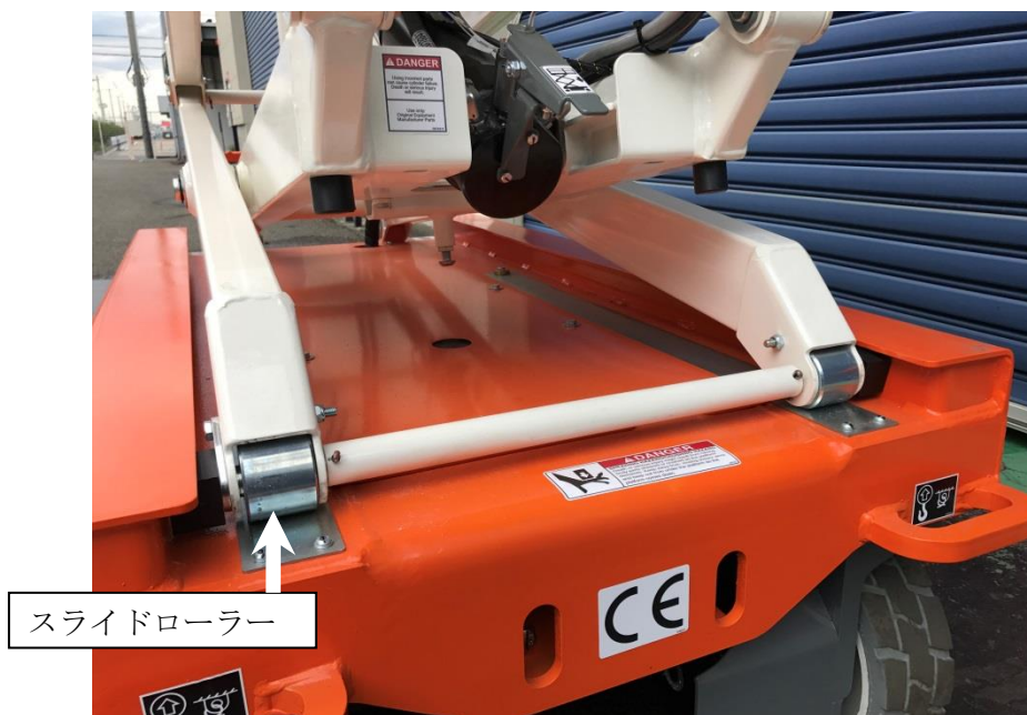
図 車体側スライドローラー
