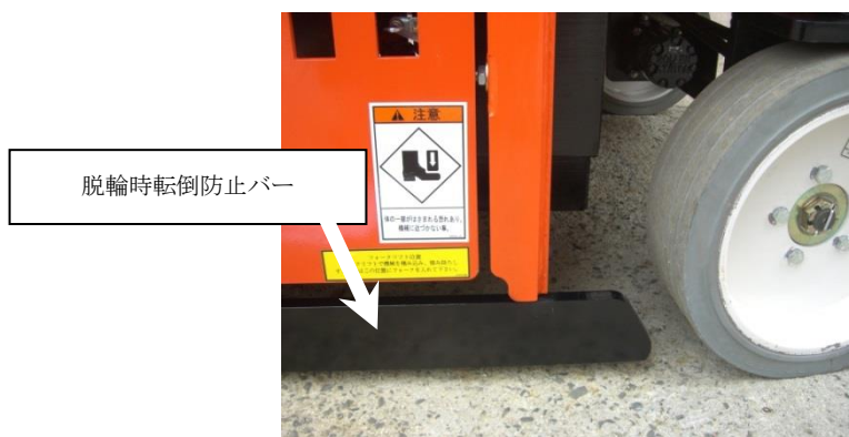
図 脱輪時転倒防止装置 (バーが降りた状態)
