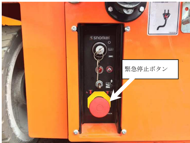
図 下部操作盤・緊急停止ボタン
