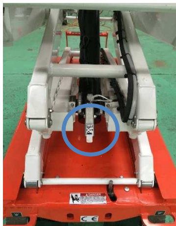
図 シャーシ前側にある緊急降下装置
