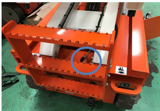
図 シャーシ後側にある緊急降下装置
