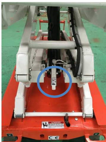
図 シャーシ前側にある緊急降下装置
