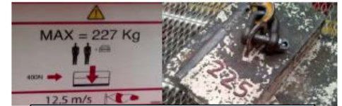
9. 作業台に安全使用荷重を載せ、ENTER を押します。
