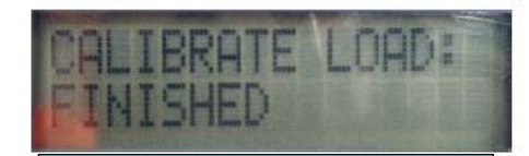
15. [FINISHED]が表示されます。これでロードセンサーの使用準備が整いました。
