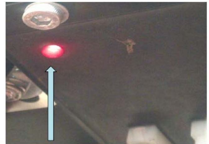
GP107 コントロールモジュール診断用 LED
