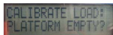
12. 作業台から荷重をすべて降ろし、ENTER を押します。
