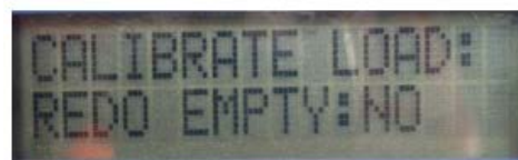
10. 積載荷重の測定が終わると、[REDO EMPTY: NO]が表示されます。
