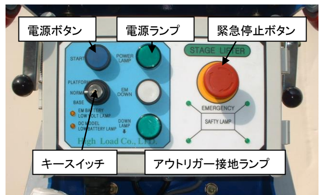
図3: 本体側操作盤
